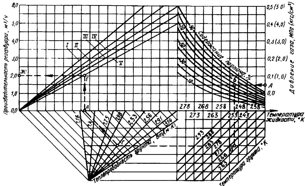
**Номограмма для определения производительности резервуара сжиженного газа вместимостью 2,5 и 5  $\text{м}^3$  (подземного)**
